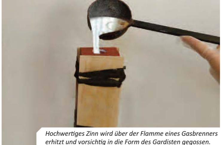
*Hochwertiges Zinn wird über der Flamme eines Gasbrenners erhitzt und vorsichtig in die Form des Gardisten gegossen.*
